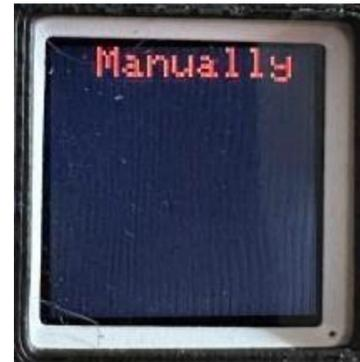
Im manuellen Modus sind die Grundfarben Rot, Grün, Blau und Weiß auf Knopfdruck zur Verfügung. Werden im manuellen Modus zwei Knöpfe gleichzeitig gedrückt so ist die Hälfte der Magic Tube mit der einen Farbe und die andere Hälfte mit der anderen Farbe beleuchtet.
