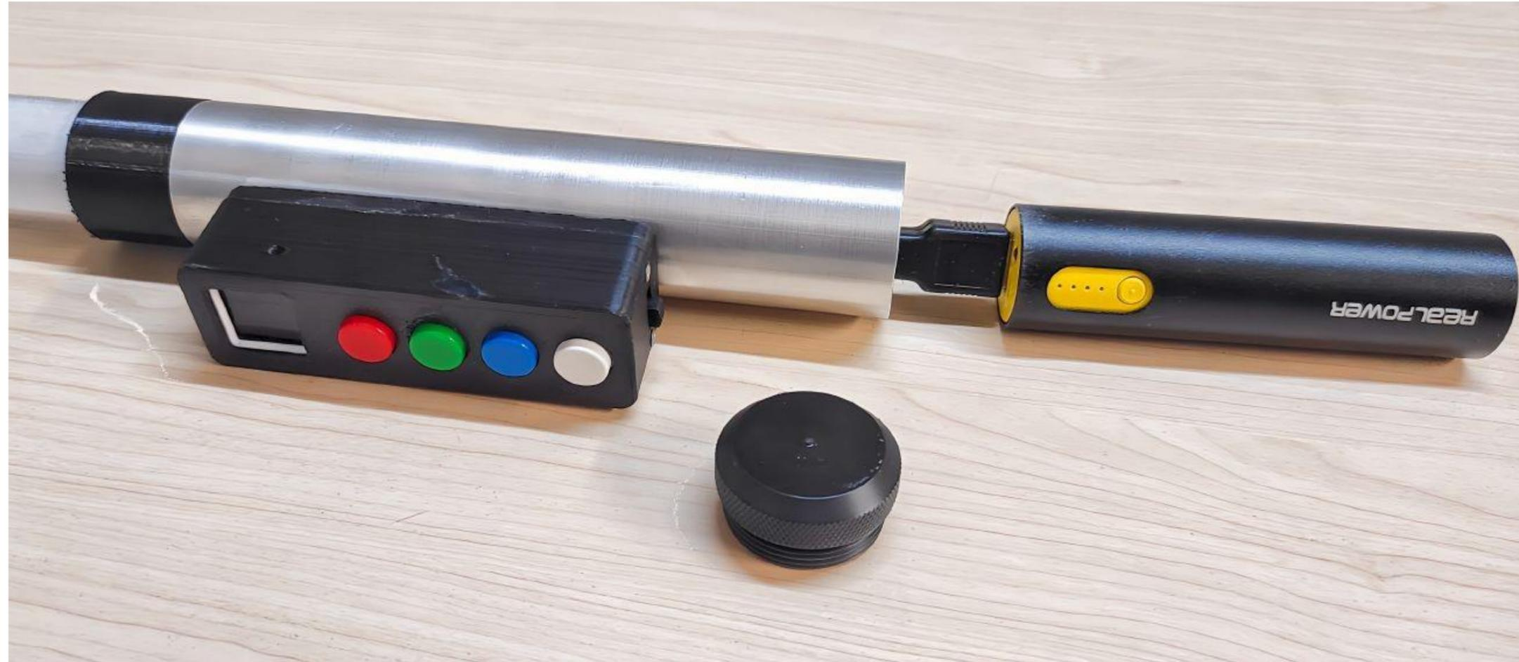
Die Powerbank wird mit dem mitgelieferten USB-Ladekabel geladen, der Ladezustand wird über die LEDs der Powerbank angezeigt
