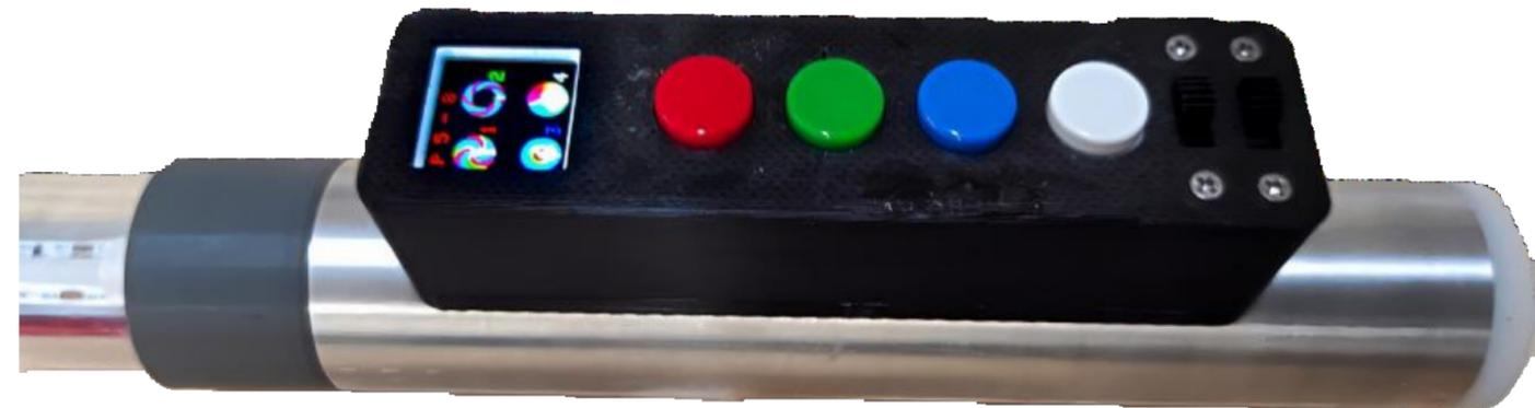
In der ersten Programm-Ebene können 4 Wunsch-Farben eingestellt werden und gespeichert werden. Dabei wird die Auswahl über den eingebauten Gyro durch einfaches Heben und Senken der Magic Tube durchgeführt. (siehe detaillierte Erklärung auf einer der nächsten Seiten)
